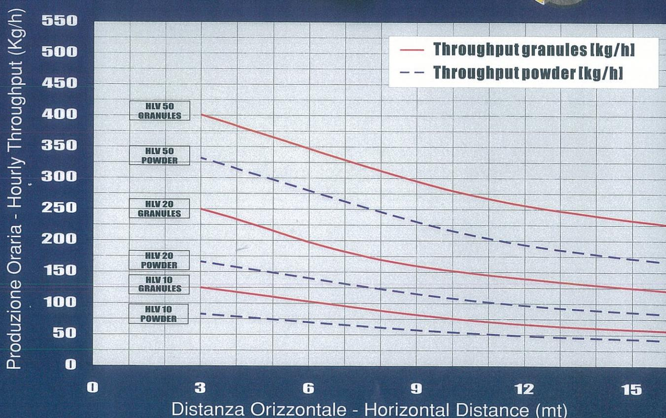
Diagrammi portate riferite a materiali in granuli con p.s.a. = 0,6 kg/dmc e polveri scorrevoli con p.s.a. = 0,55 kg/dmc. Altezza aspirazione 4 mt.
