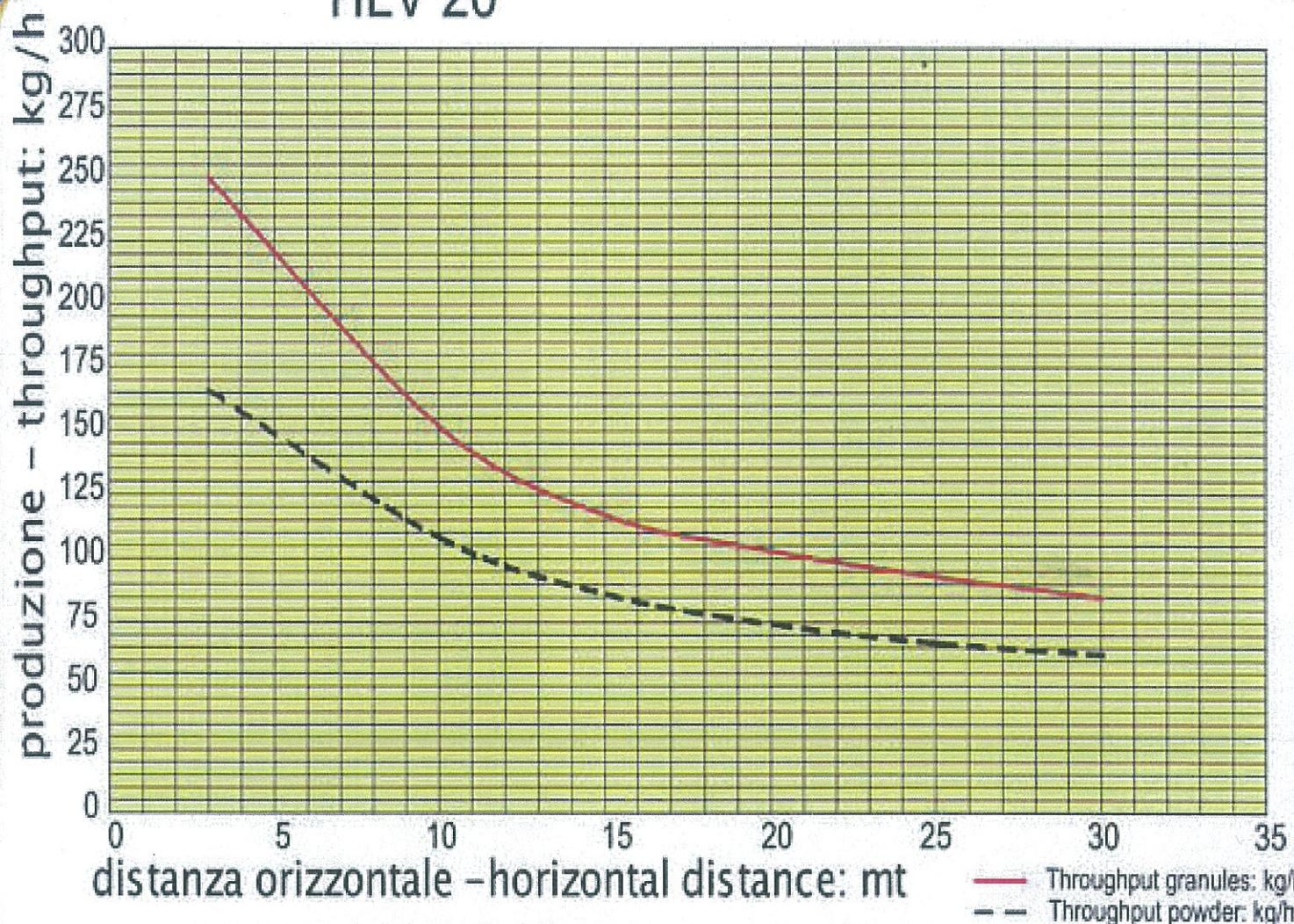
Diagrammi portate riferite a materiali in granuli con p.s.a. = 0,6kg/dmc e polveri con p.s.a.=0,55kg/dmc. Altezza aspirazione 4 mt.
