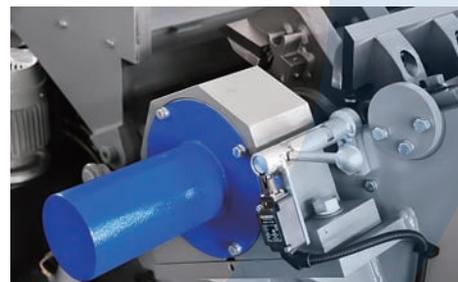
Los rodamientos reforzados se encuentran separados de la cámara de corte. De esta manera se evita que el material se contamine con el lubricante y que los rodamientos se contaminen con el material.
