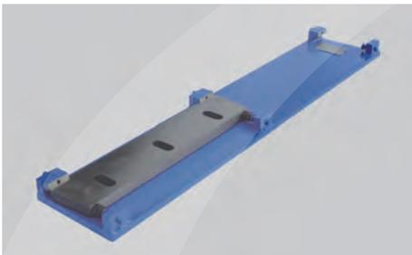
Las cuchillas fijas y del rotor se ajustan fuera de la máquina. Lo que facilita el proceso de instalación.
