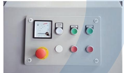
Con el fin de minimizar espacio y facilitar su movilización, los controles de la máquina y el gabinete eléctrico están integrados en la cubierta insonorizada de la máquina.
