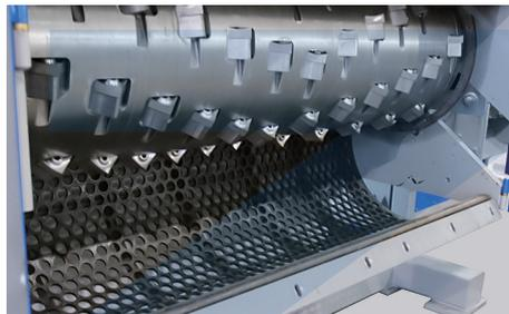
Todos los molinos Zerma poseen un rotor plano Tipo-E y los cuchillos están fijados en unos porta-cuchillos especiales, localizados en cavidades mecanizadas. Estas máquinas se pueden equipar con piezas opcionales que disminuyen su desgaste aún en procesos de materiales altamente abrasivos.
