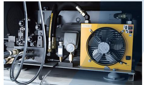
Los molinos ZXS poseen un potente sistema hidráulico de dos velocidades. Este sistema garantiza máxima presión al alimentar el material en el rotor y alta velocidad de swing.
