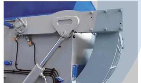
Los molinos de la serie ZSS presentan un empujador de sólida fabricación que incorpora resistentes guías de cojinetes y acoplamiento universal para garantizar una operación segura de la máquina.
