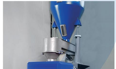
El material se alimenta en el Pulverizador a través de un canal dosificador que vibra, y la velocidad de alimentación se ajusta automáticamente al amperaje del motor y la temperatura del material.
