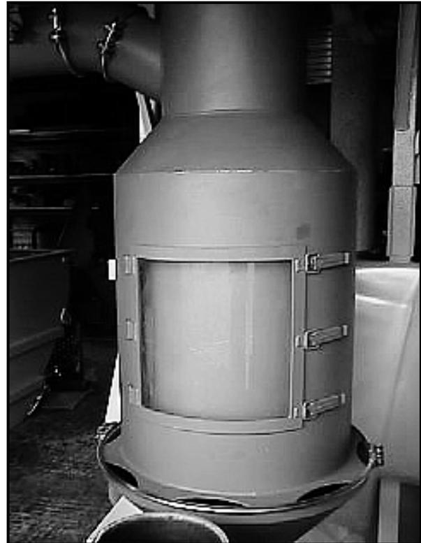
Abb. 4 Feingutabscheider Baugröße FAS 500
