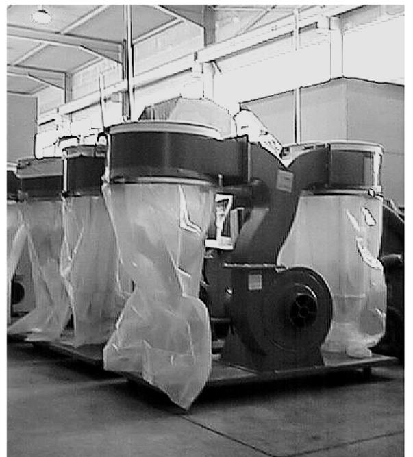
Abb. 3 Mobile Feingut-Absaugeinheit zu Feingutabscheider Baugröße FAS 300
